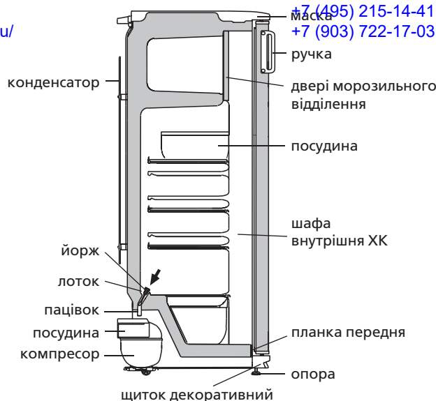
Рисунок 4 – Схема зливу талої води із ХК
